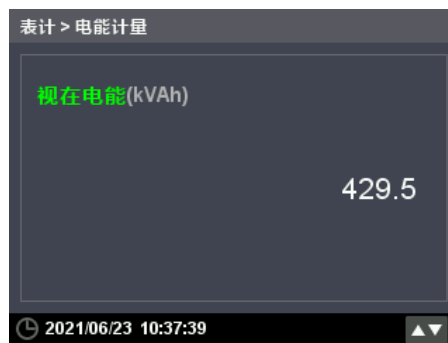
图 4-15 视在电能显示界面
