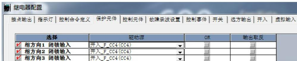
图 25: 通过输入配置方向元件闭锁
