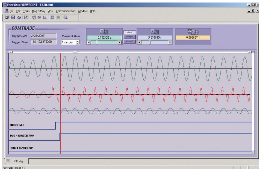
与外部故障相关的母线电流和重要的逻辑信号。尽管出现快速且严重的CT饱和，B30仍保持其稳定性。
